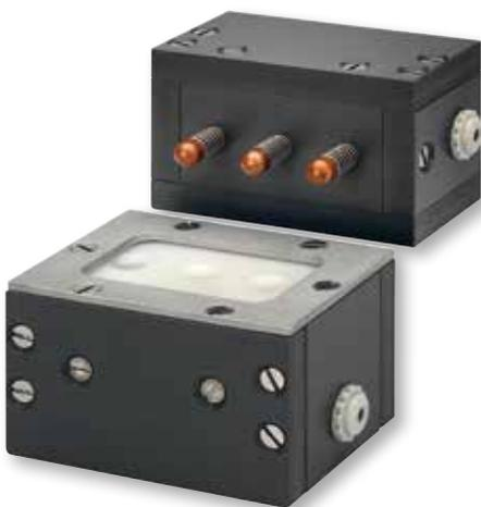
Dreipolige Kontaktierung zur Übertragung des Motorstroms bei Galvanisier-/Trommelaggregaten. Das Unterteil ist im Kontaktbereich berührungsgeschützt konstruiert (Schutzart IP 20/ fingersicher). Ebenfalls sind die Kabelanschlüsse geschützt in die Gehäuse des Ober-/Unterteils verlegt. Die Kontaktierung ist deshalb auch für 42 V Motoren einsetzbar. Auf Wunsch kann sowohl das Ober-, als auch Unterteil mit Befestigungswinkeln nach Angabe versehen werden.
