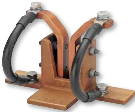
Kontaktsystem für kleinere Anlagen, z. B. im Versuchs- und Laborbereich. Die Stromübertragung erfolgt über federnd gelagerte Kontaktfinger, die mittels isolierter Strombänder mit dem Grundmodell verbunden sind. Die Kontaktflächen werden beim Eingleiten der Warenschiene durch Abrieb, soweit möglich, gereinigt. Die Standardkontakte sind ausgelegt für eine Warenschienenstärke von 10 mm.
