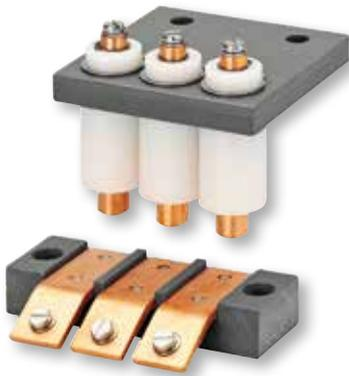
Kontaktgeber zur Übertragung des Motorstroms bei Galvanisier-Trommelaggregaten. Standardausführung nicht berührungsgeschützt, jeweils bestehend aus Ober- und Unterteil, Best.-Nr. 51205 = 3 federnd gelagerte Rundkontakte für Unterteil 51200.
