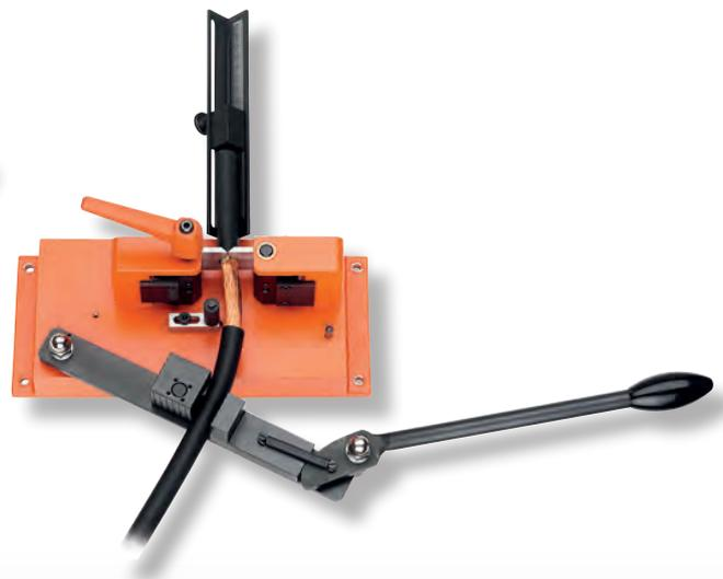
Das Kabel einlegen und bis an den Anschlag schieben. Dann Klemmhebel loslassen und Abziehhebel betätigen
